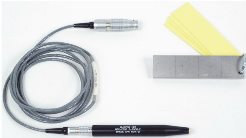
Obrázek 5-40 Materiál – tloušťka nátěru na feromagnetickém materiálu
