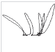
Obrázek 5-182 Příklad absolutní odezvy signálu během kontroly vířivými proudy
