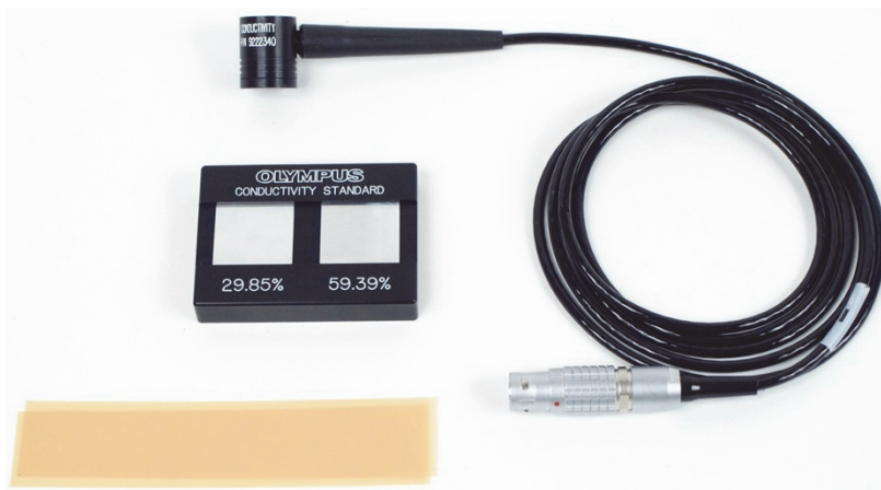
Obrázek 5-47 Materiál – vodivost a tloušťka nevodivého nátěru
