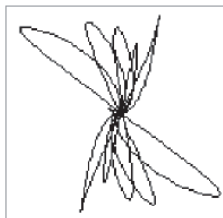
Obrázek 5-155 Ukázka diferenční odezvy signálu při kontrole vířivými proudy
