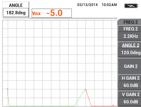
Obrázek 5-118 Úprava parametru ANGLE (úhel)
