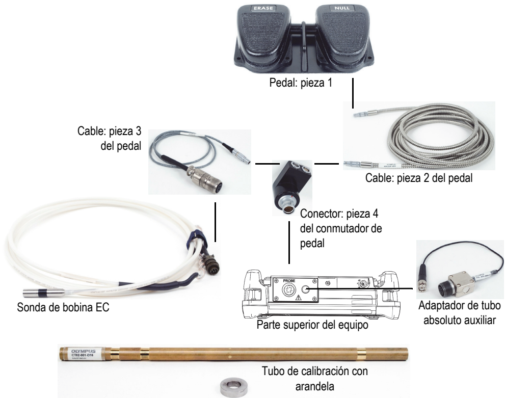
Figura 5-135 Materiales: frecuencia dual para tubos del intercambiador de calor
