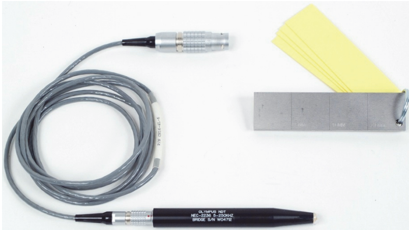
Figura 5-40 Materiales: espesores pintados en materiales ferromagnéticos
