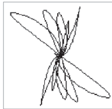
Figura 5-155 Ejemplo de una respuesta de señal diferencial por ECT
