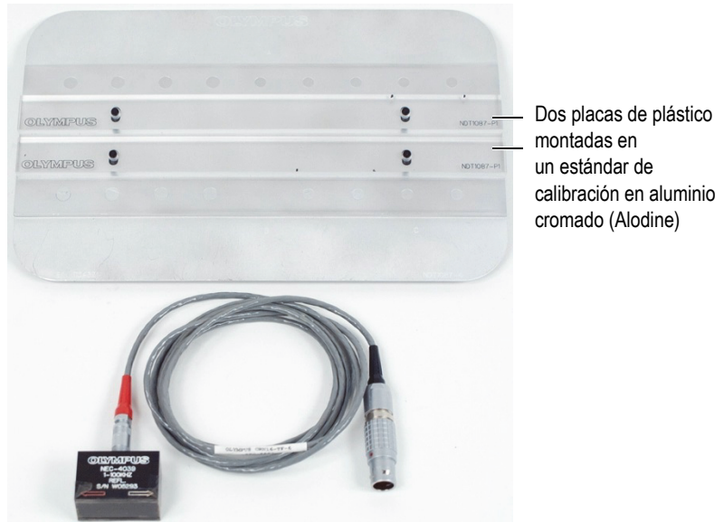
Figura 5-114 Materiales: frecuencia dual para grietas subsuperficiales
