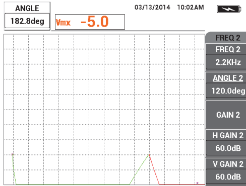
Figura 5-118 Ajuste del valor del ángulo (ANGLE)
