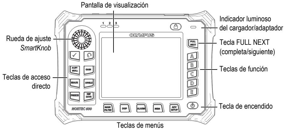
Figura 1-16 Panel frontal del equipo NORTEC 600 con la rueda de ajuste SmartKnob y el teclado
