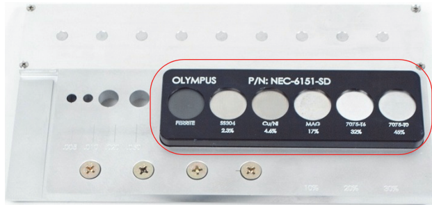
Figura 5-74 Sección del estándar de calibración utilizada para explicar la teoría del plano de impedancia
