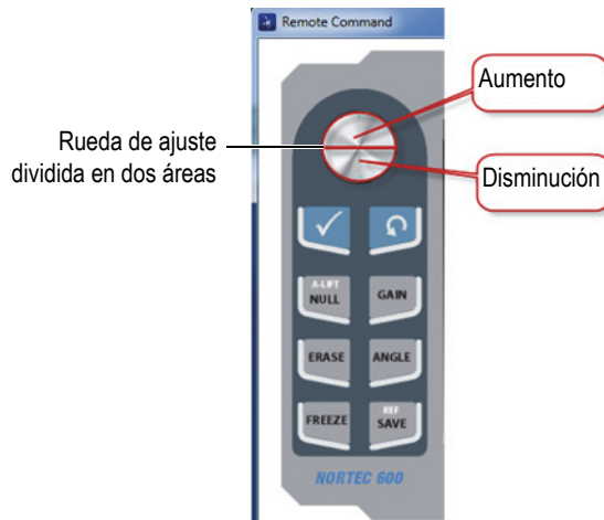
Figura 6-20 Funciones de la rueda de ajuste en el modo de control remoto/a distancia
