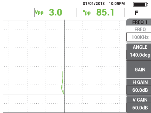
Figura 5-33 Señal de la perforación
