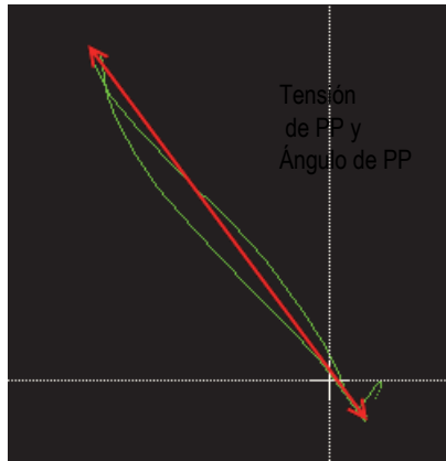
Figura 2-7 Ejemplo de tensión vertical máxima de pico a pico (VPP) y ángulo de tensión vertical máxima de pico a pico (DEG PP)
