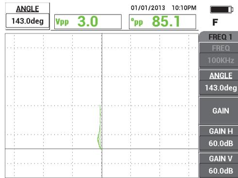
Figure 5-34 Signal de l'encoche orientée verticalement
