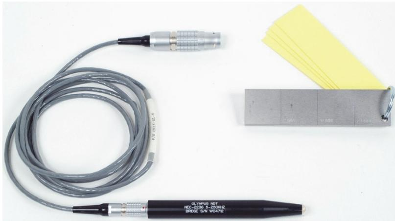
**Figure 5-40 Matériel pour inspecter l'épaisseur de la peinture sur les matériaux ferromagnétiques**
