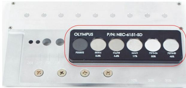
Figure 5-74 Partie du bloc étalon utilisé pour la théorie du plan d'impédance
