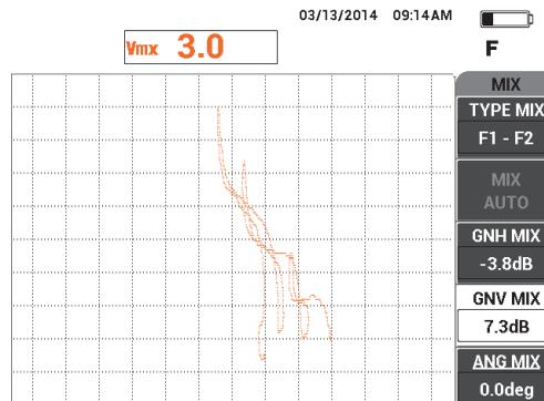
Figure 5-111 Réglage de la valeur du paramètre GNV MIX
