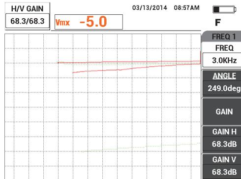
Figure 5-105 Réglage du gain pour la fréquence 1
