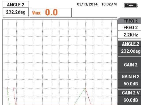
Figure 5-119 Réglage de la valeur du paramètre ANGLE 2
