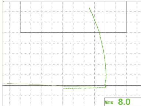
Figure 5-96 Balayage de la pièce avec une zone où la paroi est amincie
