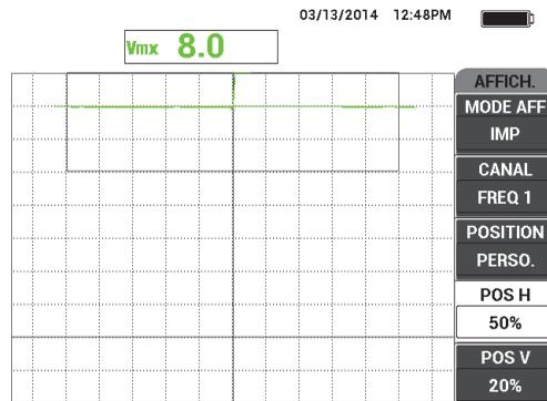
Figure 5-88 Utilisation du paramètre POS H pour créer une marque horizontale
