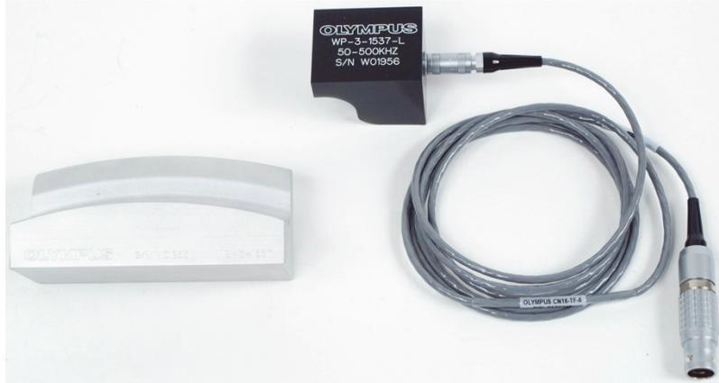
**Figure 5-53 Matériel pour inspecter les roues d'aéronefs**
