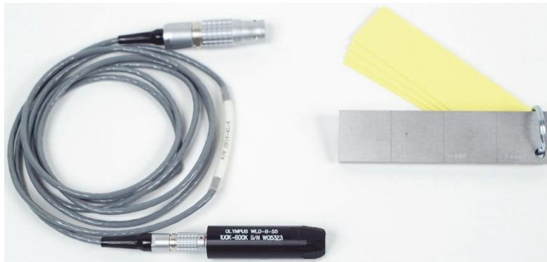
Figure 5-30 Matériel requis pour l'inspection de soudures sur les matériaux ferromagnétiques
