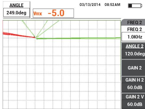
**Figure 5-101 Réglage de l'angle du signal d'entrefer pour la fréquence 1**
