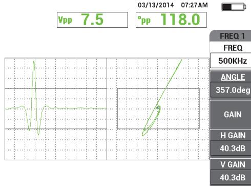
Figure 5-19 Exemple d'affichage pour une trou en acier
