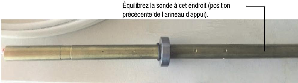
**Figure 5-176 Position d'équilibrage après avoir déplacé l'anneau d'appui**
