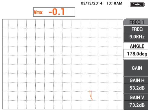
Figure 5-131 Réglage de la valeur du paramètre ANGLE
