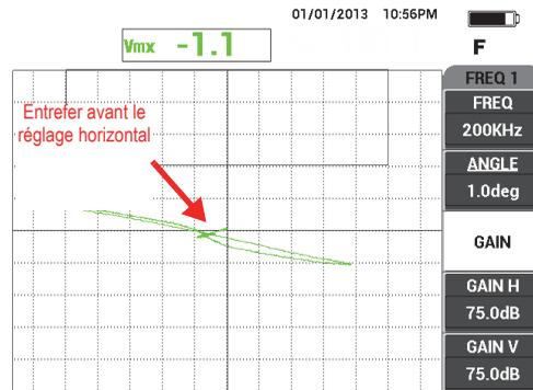
**Figure 5-56 Balayage de l'encoche centrale**
