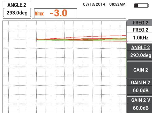
**Figure 5-102 Réglage de l'angle du signal d'entrefer pour la fréquence 2**
