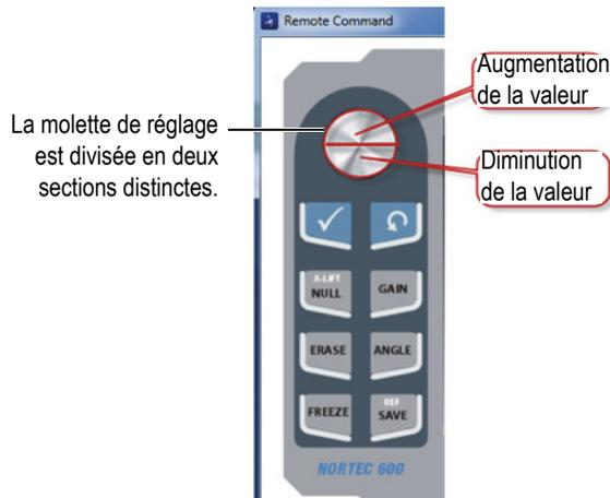
Figure 6-20 Molette de réglage en mode de fonctionnement à distance
