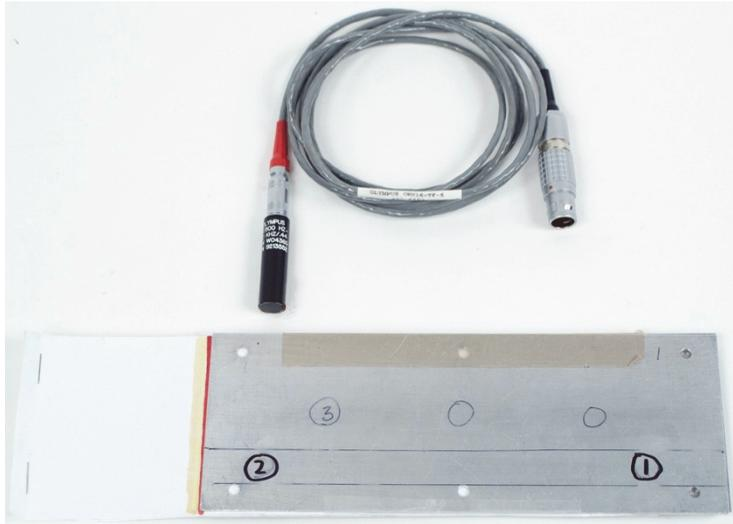
**Figure 5-97 Matériel pour inspecter la corrosion en double fréquence**
