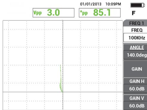
Figure 5-33 Signal obtenu sur l'encoche
