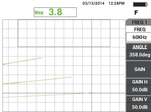
Figure 5-80 Signaux provenant de différents échantillons de conductivité
