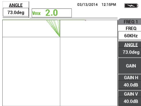
Figure 5-75 Réglage de l'angle du signal à 90°
