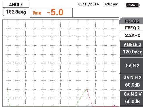
Figure 5-118 Réglage de la valeur du paramètre ANGLE
