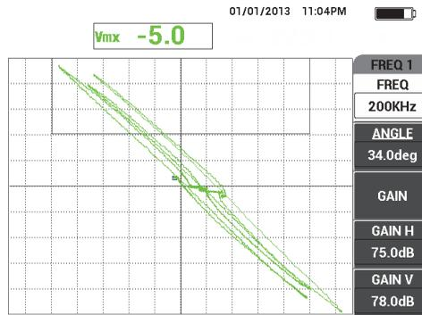
Figure 5-59 Résultats après le balayage du bloc étalon
