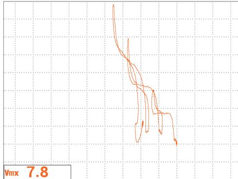
**Figure 5-112 Résultat du balayage d'un défaut de corrosion**
