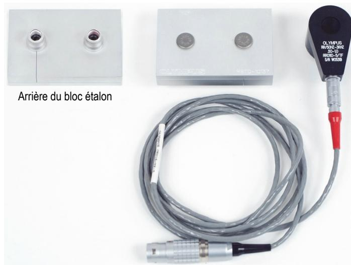
**Figure 5-22 Matériel pour inspecter les fissures sous la surface à très basse fréquence**
