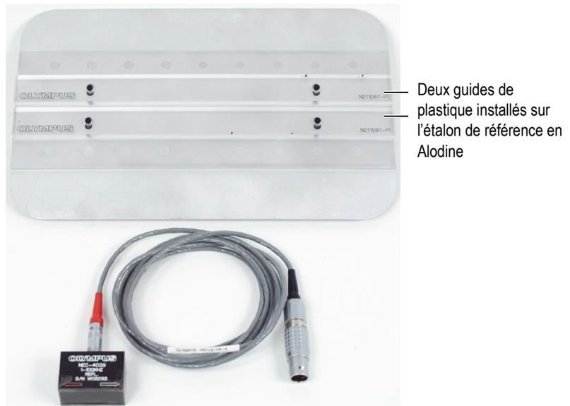
**Figure 5-114 Matériel pour inspecter les fissures sous la surface en double fréquence**
