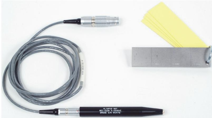
**Figura 5-40 Materiali – Spessore di vernice su materiali ferromagnetici**
