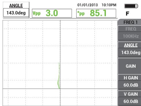
Figura 5-34 Il segnale dell'intaglio orientato verticalmente
