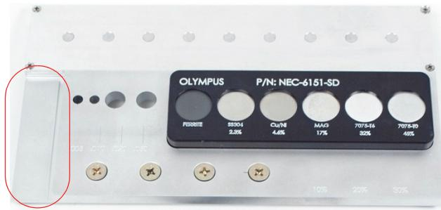
**Figura 5-92** La sezione del campione usata per lo spessore del metallo
