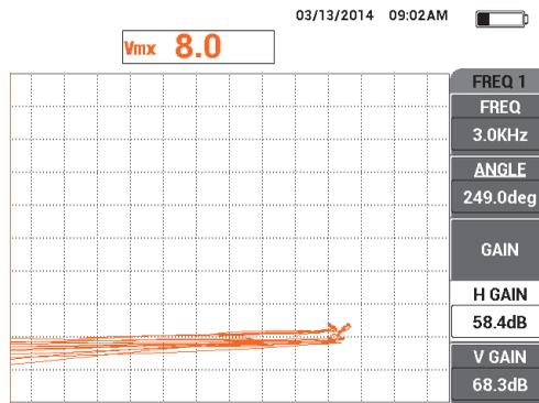
**Figura 5-107 Regolazione del GUAD.O. per la frequenza 1**
