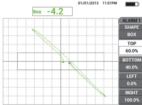
**Figura 5-60 I parametri di allarme**
