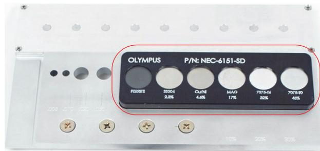
Figura 5-74 La sezione del campione usato per la teoria del diagramma di impedenza
