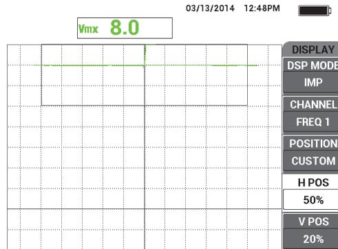
**Figura 5-88** Uso del parametro POS.O. per creare un'indicazione orizzontale
