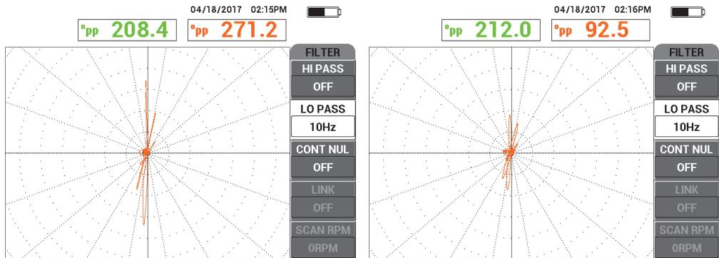
Figura 5-206 Una scansione con il filtro PASSA BASSO da 10 Hz (a sinistra) e con una velocità di scansione eccessivamente veloce (a destra)
