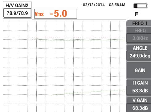
Figura 5-106 Regolazione del guadagno per la frequenza 2
