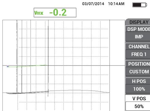
**Figura 5-45** Uso delle indicazioni di riferimento verticali per la valutazione dello spessore
