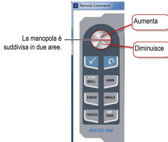
Figura 6-20 Funzione della manopola in modalità di controllo remoto
