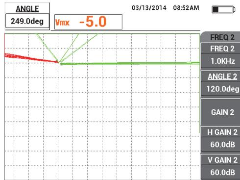
**Figura 5-101 Regolazione dell'angolo del segnale di lift-off della frequenza 1**
