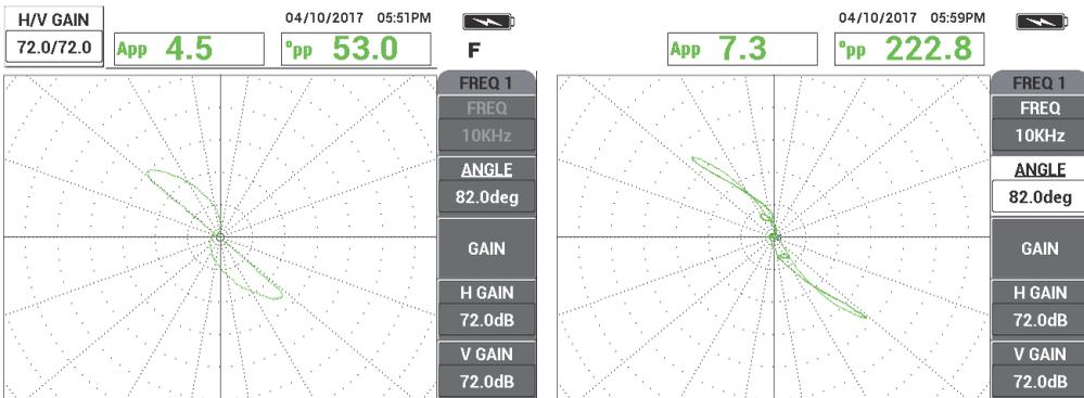
Figura 5-166 I segnali verificati: foro passante (a sinistra) e anello di supporto (a destra)
