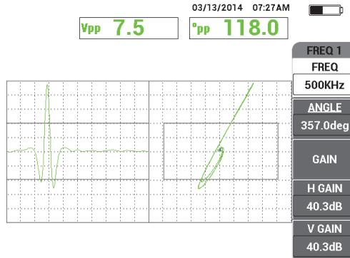
Figura 5-19 Un esempio di schermata per un foro nell'acciaio
