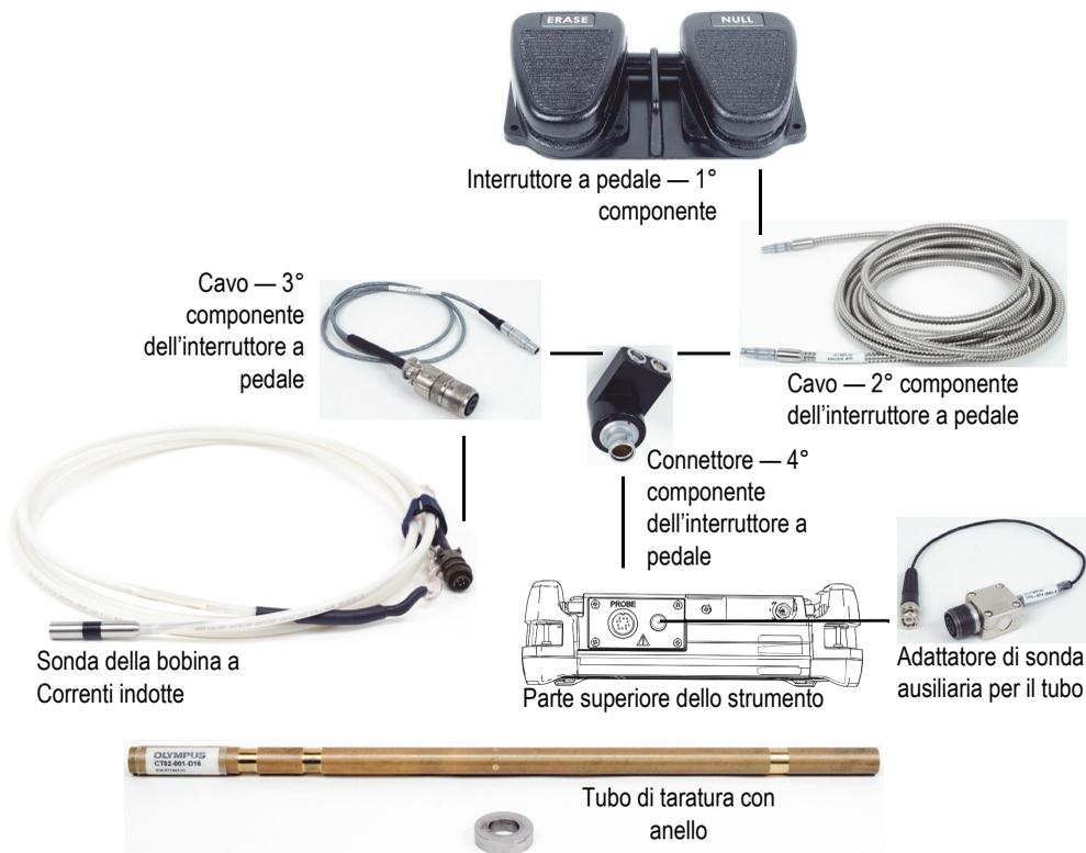
**Figura 5-135 Materiali — Frequenza doppia per le tubi di scambiatori di calore**
