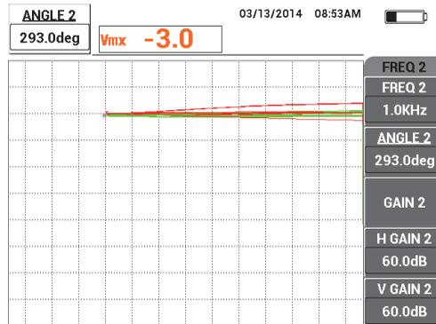
**Figura 5-102 Regolazione dell'angolo del segnale di lift-off della frequenza 2**
