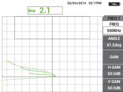
**Figura 5-3 La funzione di lift-off automatico**
