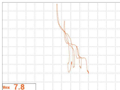
**Figura 5-112 Il risultato della scansione del difetto da corrosione**
