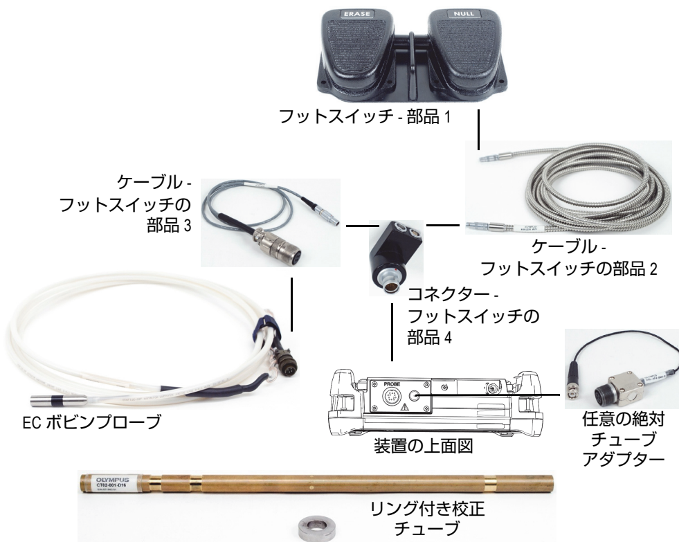
図 5-133 材料 - 放熱機構チューブ用二重周波数
