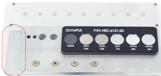
図 5-90 金属の厚さに使用される標準試験片部分
