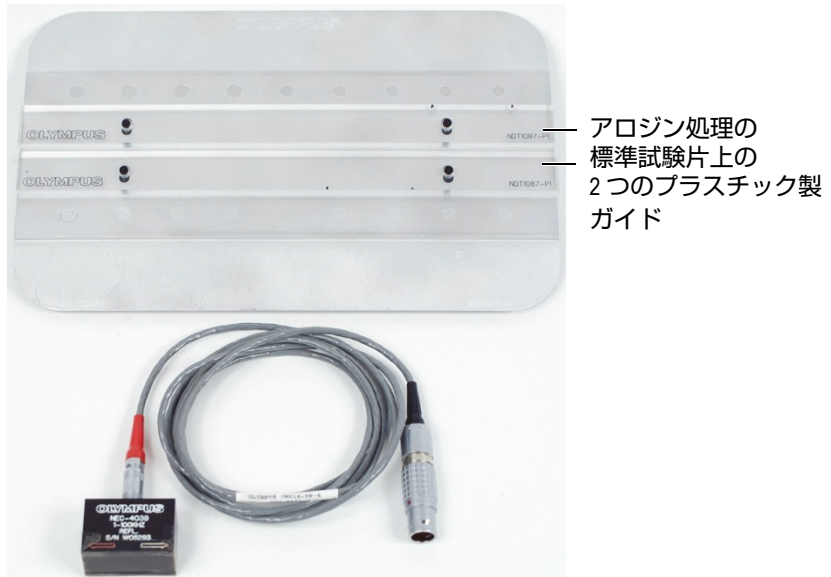
図 5-112 材料 - 近表面欠陥のための二重周波数
