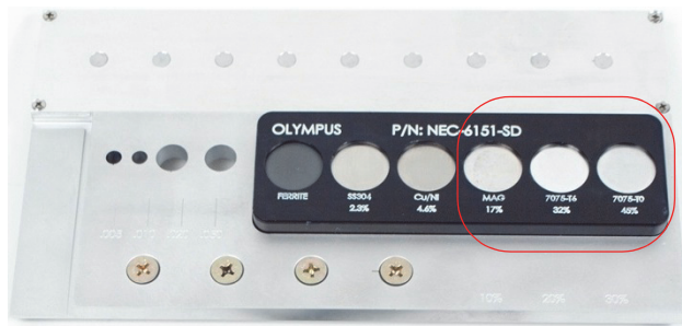
図 5-77 導電率評価に使用される標準試験片部分
