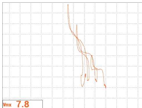
Figura 5-111 Resultado do rastreamento de defeitos de corrosão
