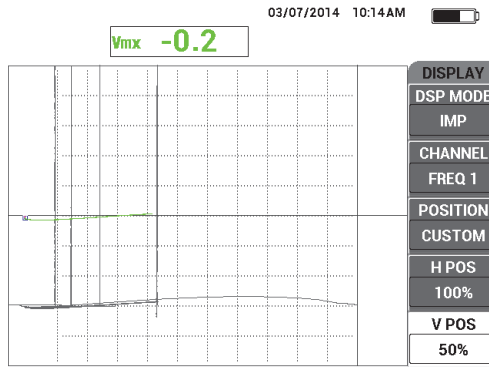
Figura 5-45 Usar as marcas de referências verticais para avaliar a espessura
