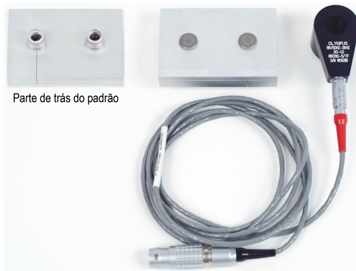
Figura 5-22 Materiais — fissuras em subsuperfícies em frequência muito baixa
