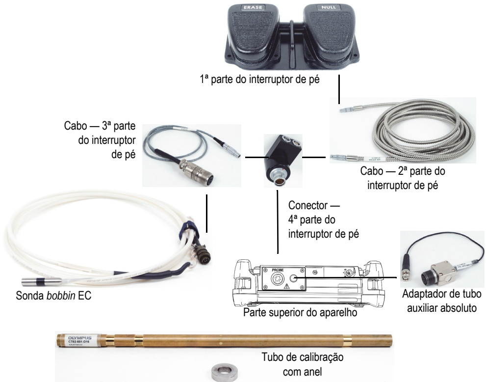
Figura 5-134 Materiais — frequência dupla para tubo de trocador de calor
