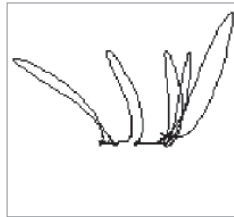
Figura 5-181 Exemplo de resposta de sinal absoluto ECT
