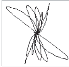
Figura 5-154 Exemplo de resposta de sinal diferencial ECT
