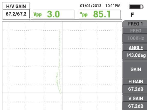
Рис. 5-35 Настройка вертикального усиления
