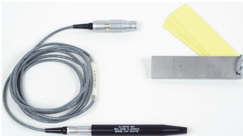
Рис. 5-40 Инструменты для определения толщины краски на ферромагнитных материалах
