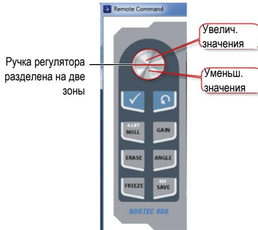
Рис. 6-20 Функции ручки регулятора в режиме удаленного контроля
