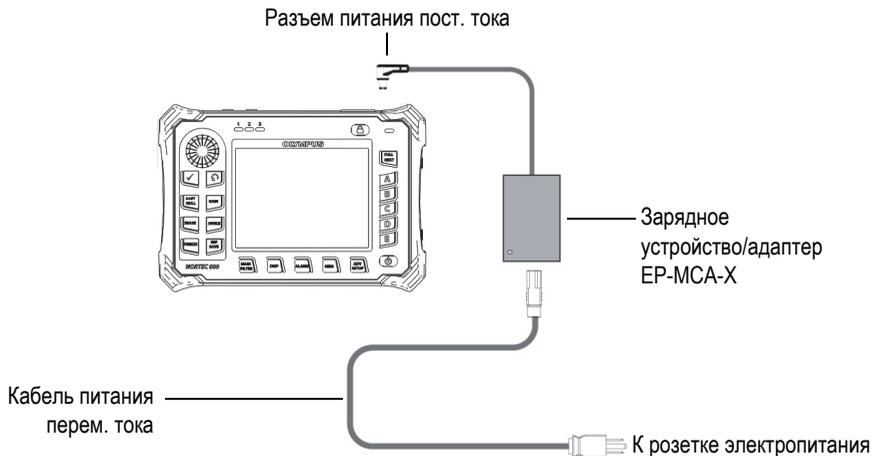
**Рис. 1-8 Подключение зарядного устройства/адаптера**
