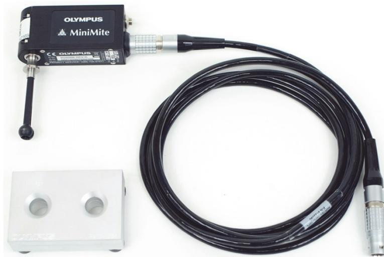
**Рис. 5-10 Оборудование для контроля крепежных отверстий**
