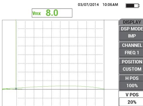
Рис. 5-43 Настройка В ПОЛ для создания вертикальной линии
