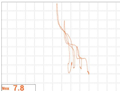
Рис. 5-112 Результат сканирования коррозионных дефектов
