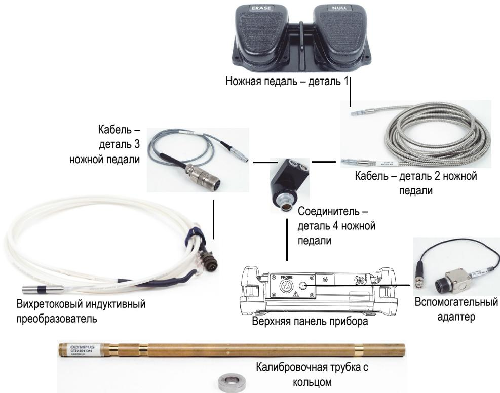
**Рис. 5-135 Материалы для контроля теплообменных труб в двухчастотном режиме**
