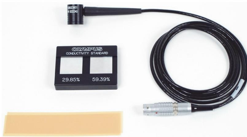
**Рис. 5-47 Инструменты для измерения проводимости и толщины непроводящего покрытия**
