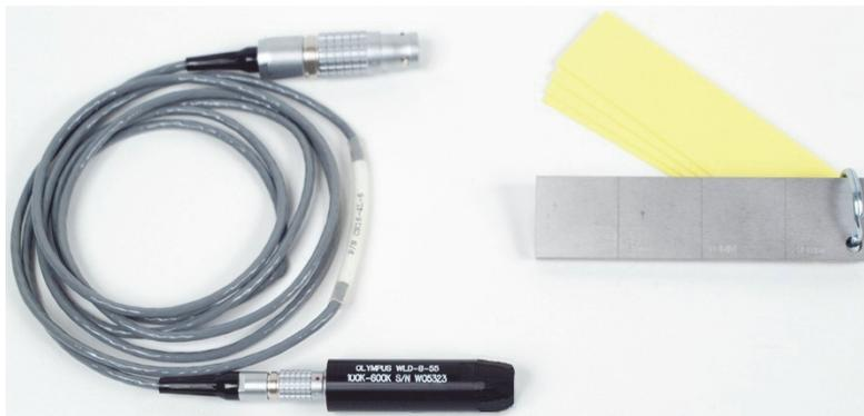
Рис. 5-30 Необходимые компоненты для контроля сварных швов изделий из ферромагнитных материалов
