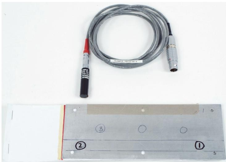
Рис. 5-97 Оборудование для выявления коррозии в двухчастотном режиме
