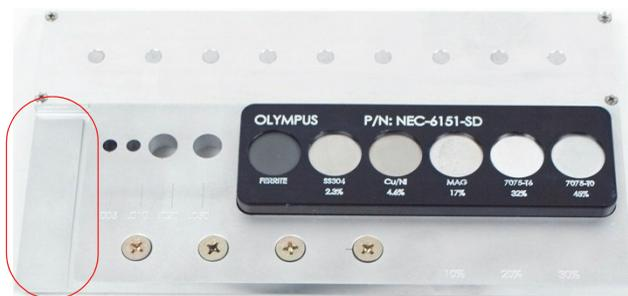
Рис. 5-92 Часть образца, используемая для измерения толщины металла
