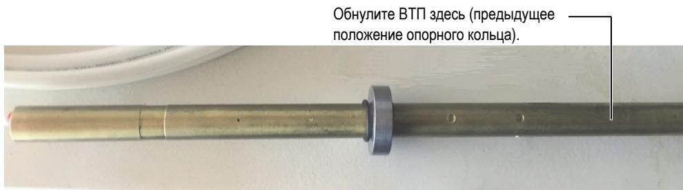
Рис. 5-176 Нулевое положение после перемещения опорного кольца
