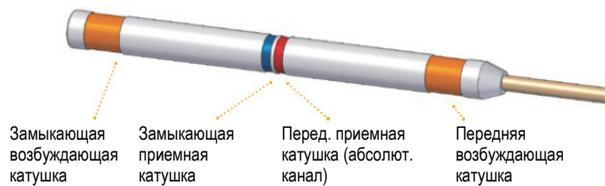
**Рис. 5-191 Преобразователь с двумя возбудителями**
