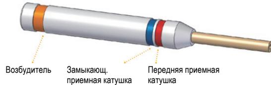
**Рис. 5-210 Преобразователь с одним возбудителем**
