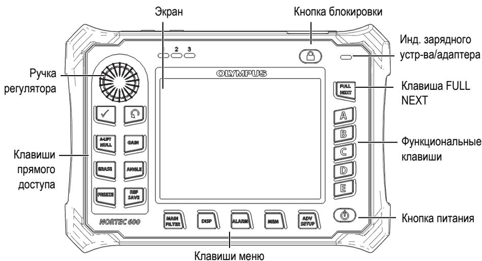
Рис. 4-2 Элементы управления NORTEC 600
