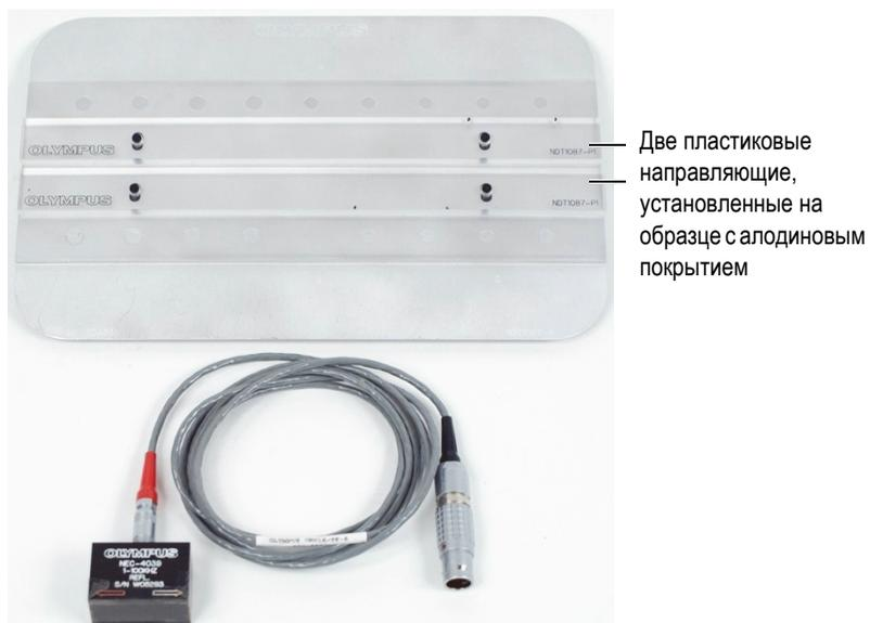
**Рис. 5-114 Оборудование для выявления подповерхностных трещин в двухчастотном режиме**
