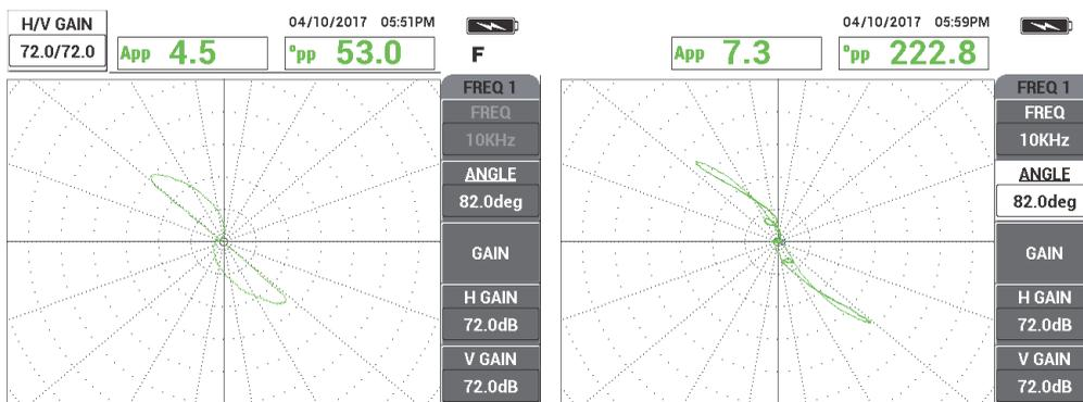
Рис. 5-166 Проверенные сигналы: от сквозного отверстия (слева) и от опорного кольца (справа)
