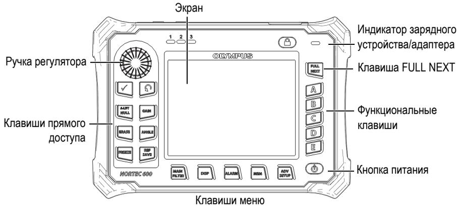
Рис. 1-16 Передняя панель NORTEC 600 с клавиатурой и ручкой регулятора
