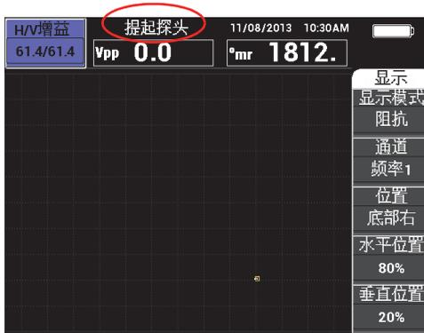
图 4-4 按下自动脱离 / 平衡键后出现的提起探头信息
