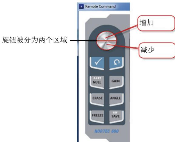
图 6-20 远程控制操作中的旋钮功能
