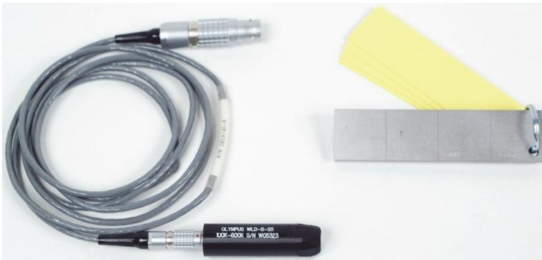
图 5-30 所用材料 — 检测铁磁性材料上的焊缝
