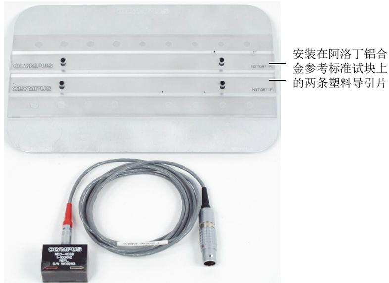
图 5-114 所用材料 — 使用双频探测近表面裂纹
