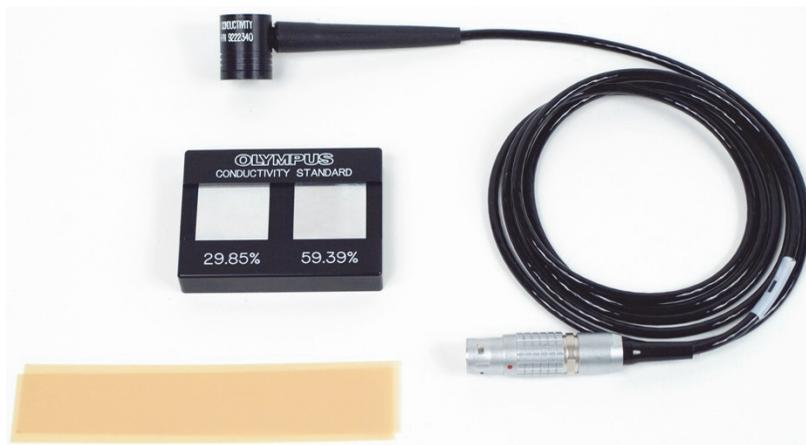
图 5-47 所用材料 — 测量电导率和非导电性涂层厚度
