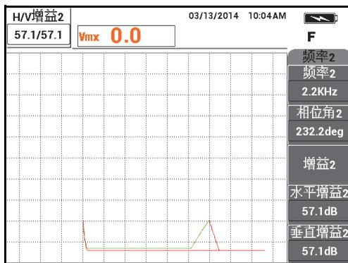
图 5-121 调节频率 2 信号的波幅
