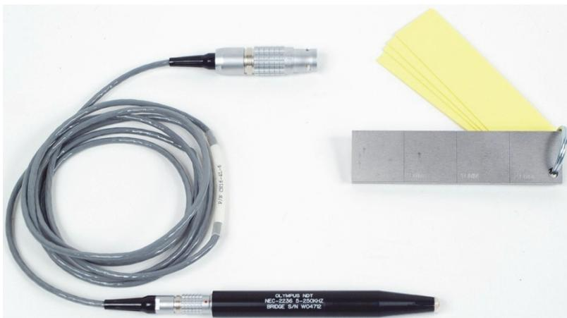
图 5-40 所用材料 — 检测铁磁性材料的漆层厚度
