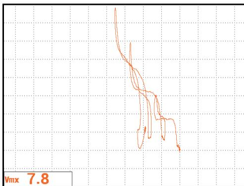
图 5-112 腐蚀缺陷的扫描结果
