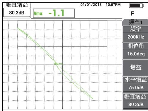
图 5-58 信号在屏幕的垂直方向上延伸
