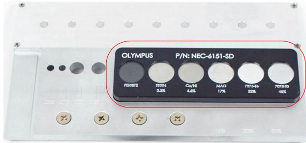
图 5-74 标准试块上用于说明阻抗平面图理论的部分
