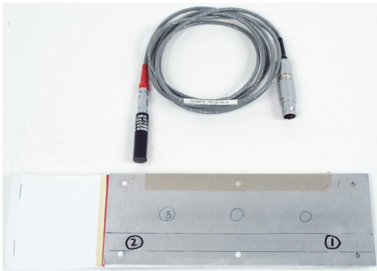
图 5-97 所用材料 — 使用双频探测腐蚀缺陷
