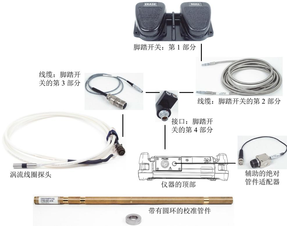
图 5-135 所用材料 — 使用双频检测热交换器管件
