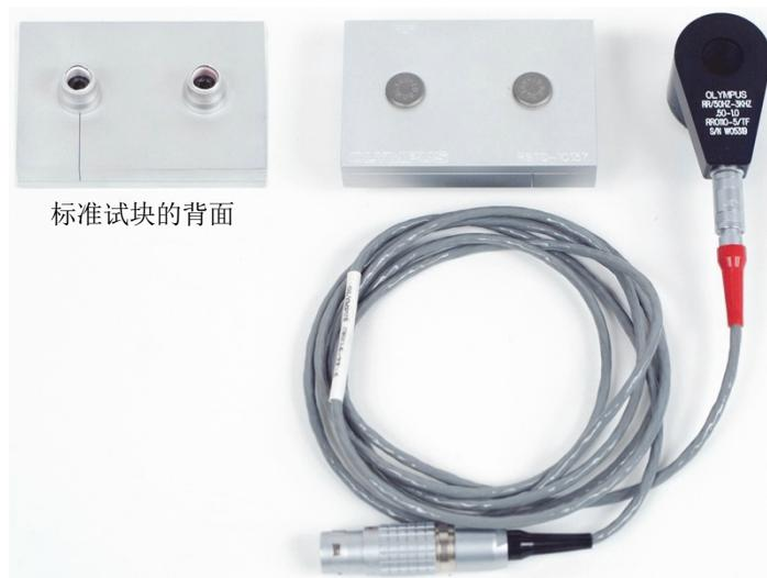
图 5-22 所用材料 — 以极低的频率探测近表面裂纹
