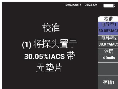
图 5-49 接受 PowerLink 设置后出现的指导（1）
