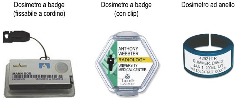
**Figura 2-3 Dosimetri – Vari modelli**
