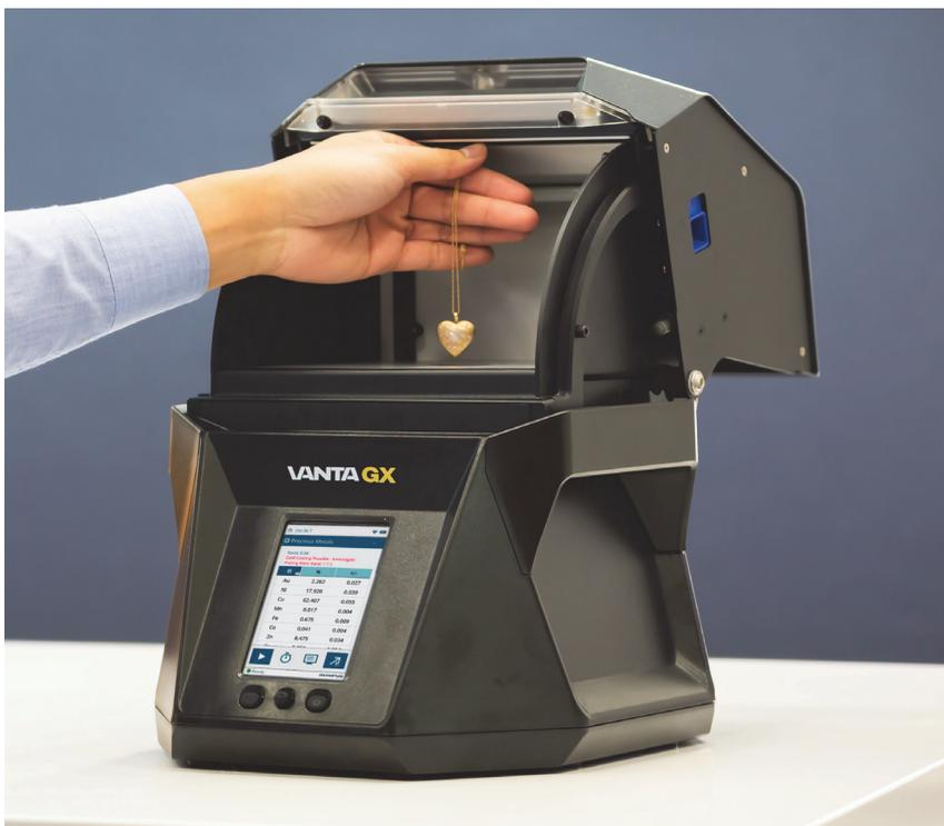
**Figura 3-2 Esempio: Una collana d'oro posizionata sull'apertura di analisi**
