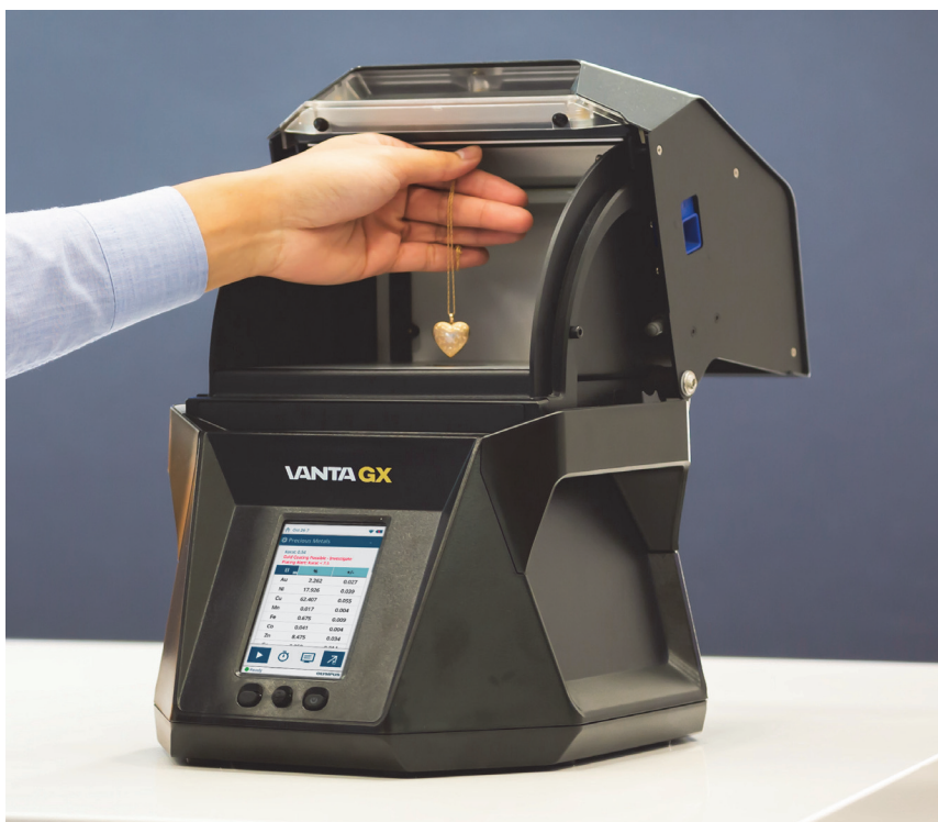
图 3-2 示例：将金首饰放置于测量窗口上
