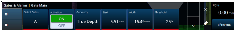
Obrázek 2-27 Gates &amp; Alarms PA – Gate Main menu (Brány a alarmy PA – Nabídka Hlavní brána)
