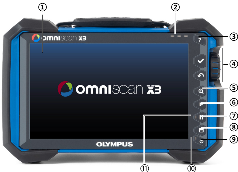
Obrázek 1-1 Ovládací prvky na čelním panelu defektoskopu OmniScan X3
