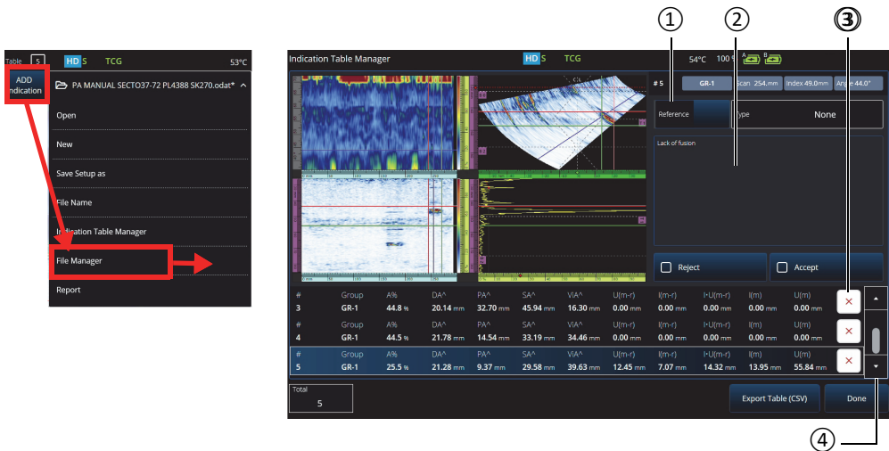
Figura 5-2 Ventana del administrador de tablas de defectos
