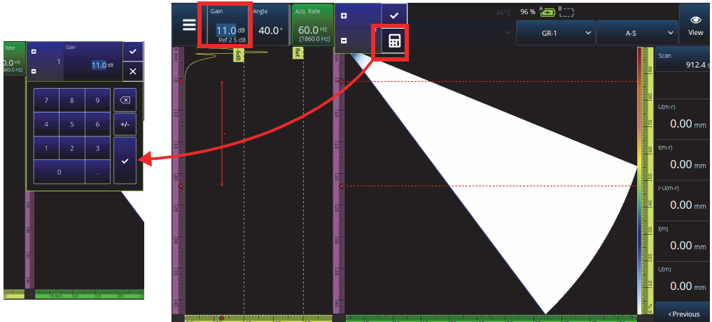
Figure 2-10 Réglage des paramètres à l'aide des flèches haut/bas ou du clavier
