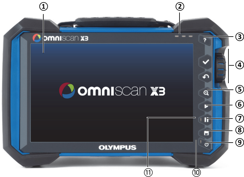
Figure 1-1 Composants du panneau avant de l’OmniScan X3
