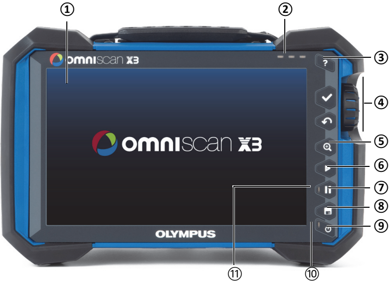
Figura 1-1 Comandi del pannello frontale del rilevatore di difetti OmniScan X3
