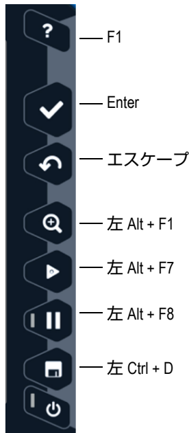
図 10-4 OmniScan X3 ユニットのショートカット
