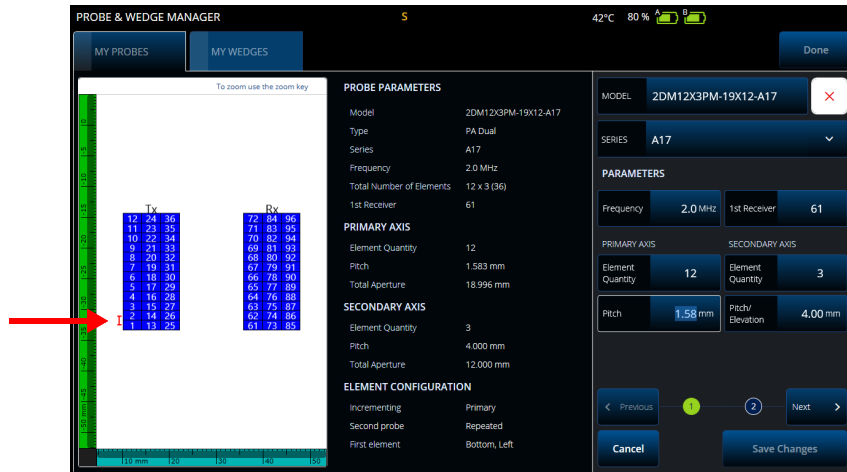
図 6-10 PA 二振動子型プローブの編集 – 選択したパラメータを赤色のインジケータが強調
