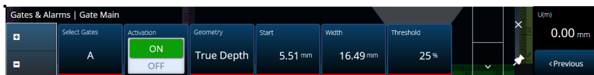
図 2-27 Gates & Alarms PA (ゲートとアラーム (PA)) – Gate Main (メインゲート) メニュー
