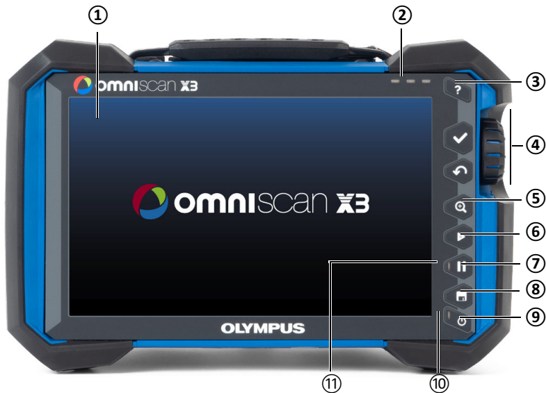
図 1-1 OmniScan X3 探傷器のフロントパネルのコントロール部
