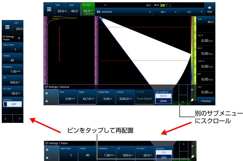
図 2-3 パラメーターサブメニューのスクロールと再配置
