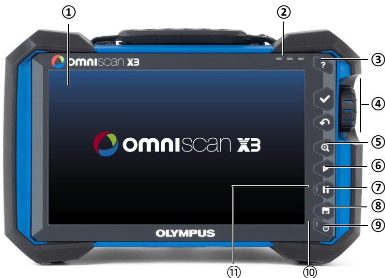
Rysunek 1-1 Elementy sterujące na przednim panelu defektoskopu OmniScan X3
