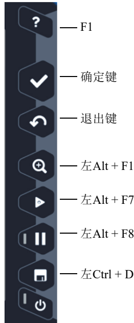
图 10-4 OmniScan X3 仪器的快捷方式
