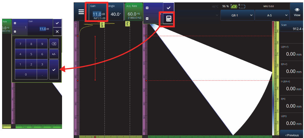
图 2-10 使用向上 / 向下箭头键或小键区调整参数
