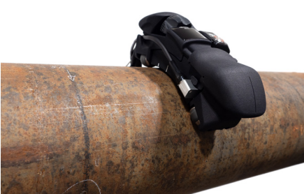
SFA1-FLEXO 管道的纵向扫查
