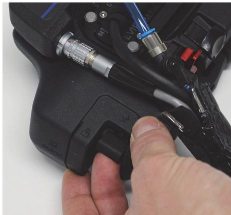
Figure 4-7 Manipulation du codeur d'index
