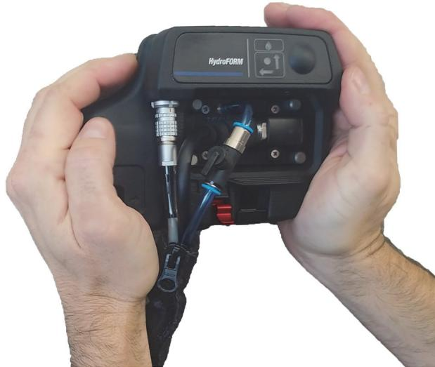
Figure 4-2 Positions des mains pendant l'indexation
