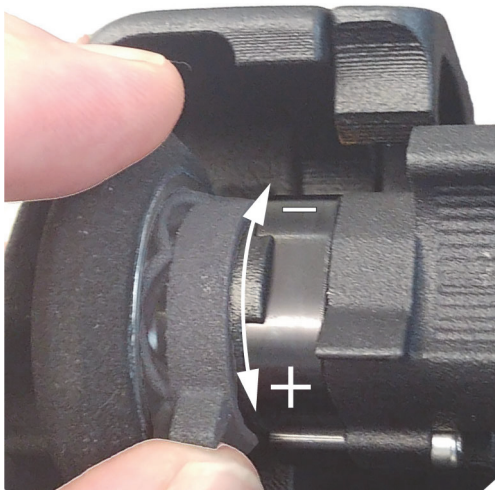
图 3-2 编码器轮子的阻力
