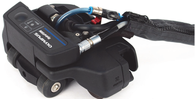
图 1-1 配备了ScanDeck模块和步进编码器的HydroFORM扫查器
