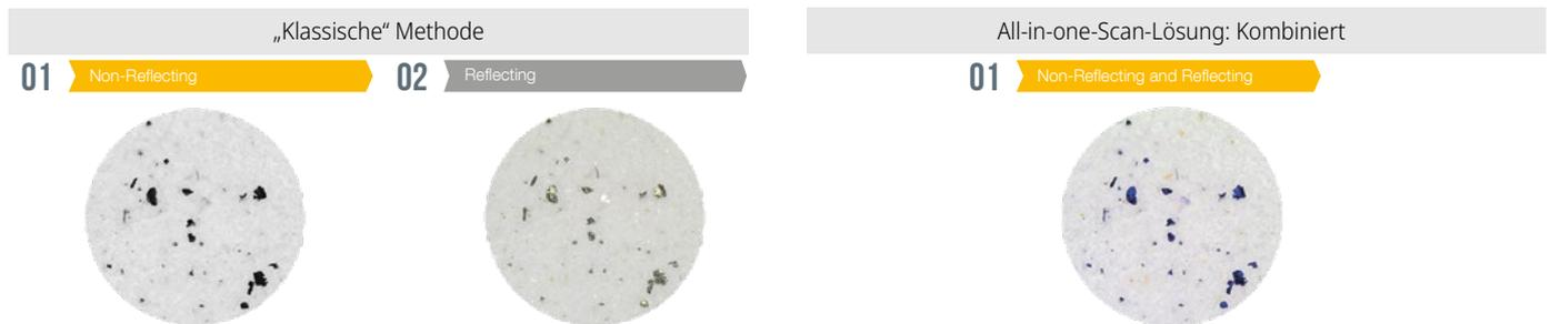
Ein innovatives Polarisationsverfahren erfasst sowohl reflektierende (metallische) als auch nicht reflektierende Partikel in einem einzigen Scan.
