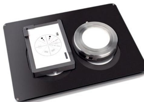
La norma di taratura integrata contribuisce ad assicurare la verifica del sistema con regolarità
