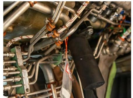
Nach dem Befestigen des Sweeney Digital Turning Tools an der Zugangsöffnung des Turbinenmotors werden die Turbinenschaufeln durch den Antriebsmotor gedreht.
