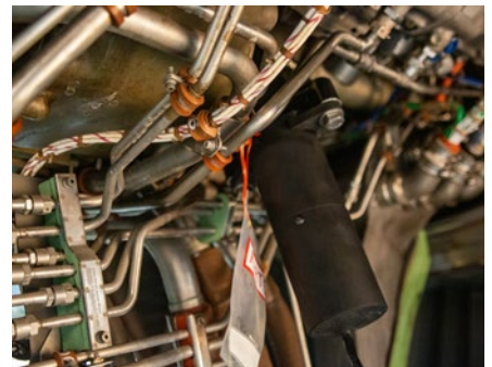
Sweeney 디지털 터닝 툴을 엔진 액세스 포트에 부착하면 드라이브 모터를 통해 터빈 블레이드를 회전할 수 있습니다.
