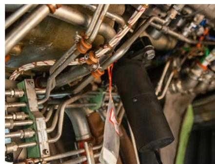
将Sweeney数字型转动工具安装在发动机检修口，该工具的驱动电机可以使您转动涡轮叶片。
