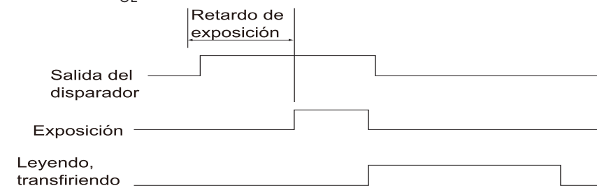
Esquema temporal en la adquisición de imágenes fijas (en el caso de definir una lógica positiva)
