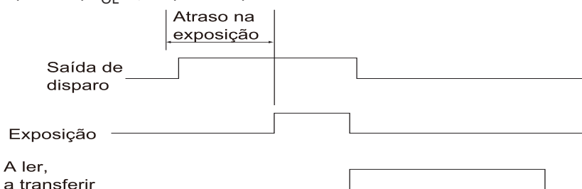
Diagrama de temporização na aquisição de imagens fixas (no caso de definição de uma lógica positiva)
