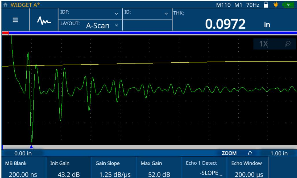
Abbildung 4-2 Erhöhung der Anfangsverstärkung (nachher)
