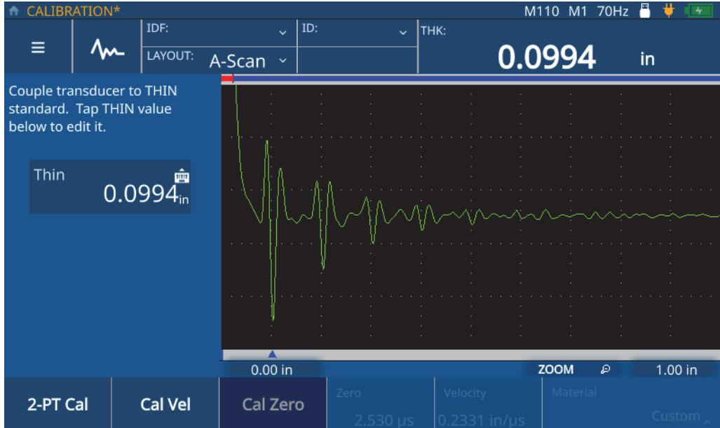
Figure 5-10 Étalonnage du zéro (étalonnage en deux points)
