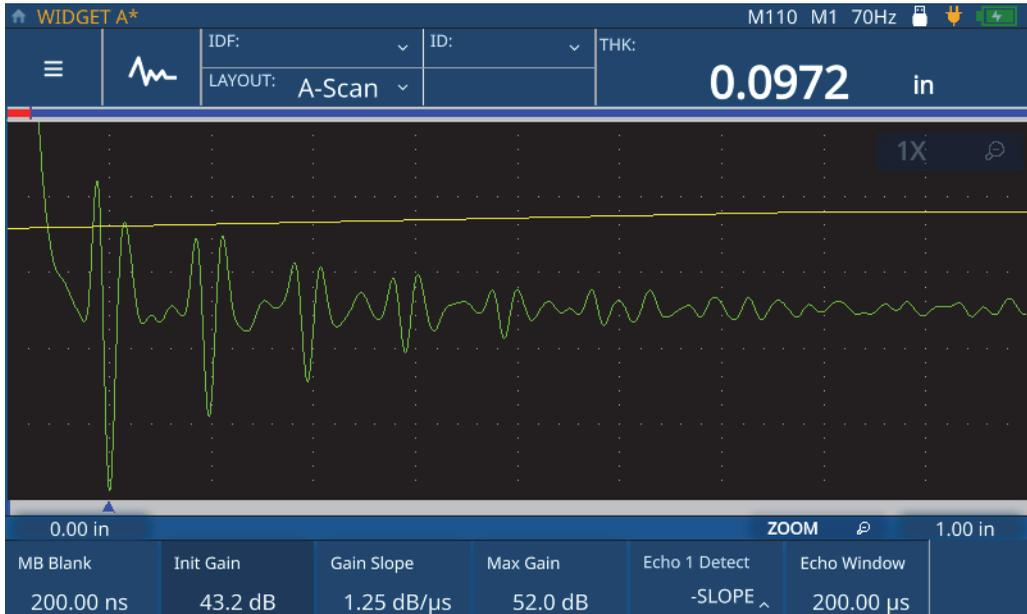
Figure 4-2 Exemple d'augmentation du gain initial (après)
