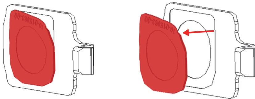
图 4-6 拨开窗口的一角（左图），并撕下窗口（右图）
