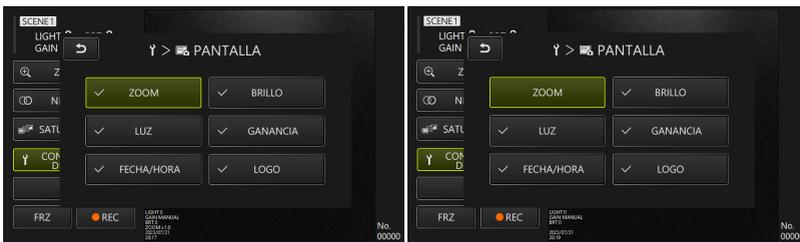
Con el elemento deseado seleccionado con la tecla de dirección de la unidad de control, pulse brevemente el botón [ENT/MODE] o haga clic/toque la tableta para añadir o quitar marcas de verificación.
