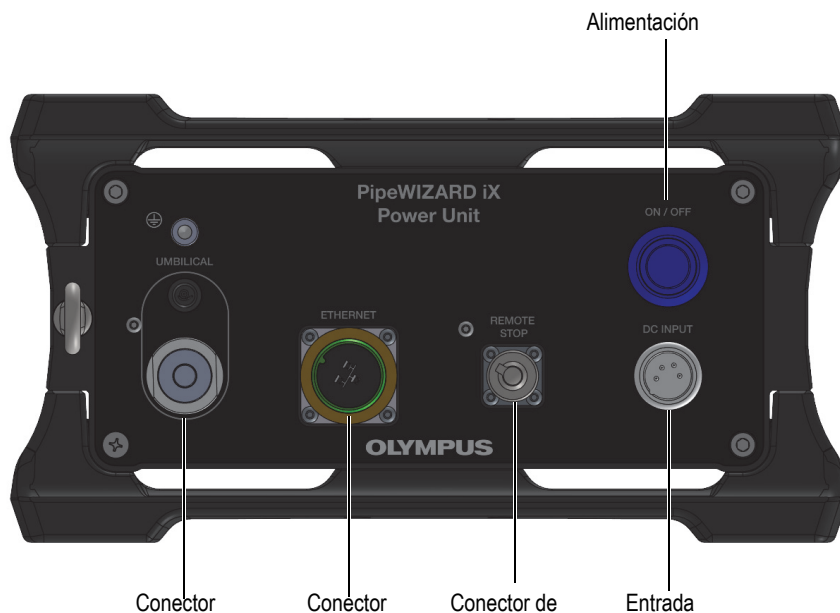
Figura 1-2 Conexiones de la unidad de alimentación y botón de alimentación
