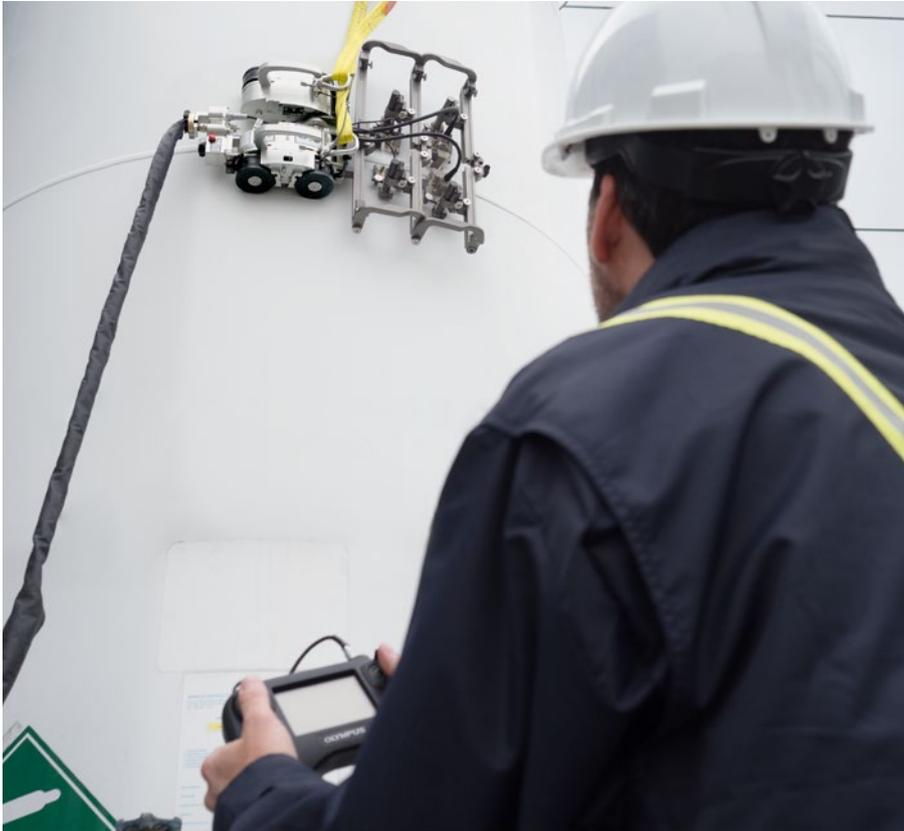
El escáner motorizado SteerROVER™ es una solución de escaneo magnético orientable, robusta y fácil de operar. Oriente el escáner a distancia usando el robusto control remoto portátil, dotado de una pantalla claramente legible. Utilícelo para simplificar las inspecciones de grandes superficies ferromagnéticas, como los recipientes a presión y tanques, y logre inspecciones fiables por ultrasonido multielemento (*Phased Array*) en aquellas áreas difíciles de alcanzar.
