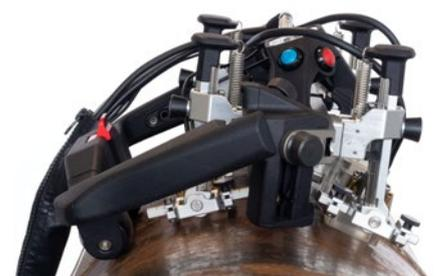
Junto con cuatro sondas, el escáner AxSEAM puede inspeccionar tuberías de forma circunferencial desde 254 mm (10 pulg.) de D. E.
