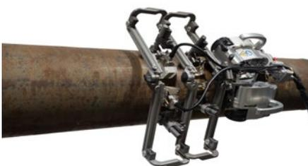
El escáner SteerROVER y el bastidor de soporte de sonda pueden adaptarse a la inspección de soldaduras longitudinales.
