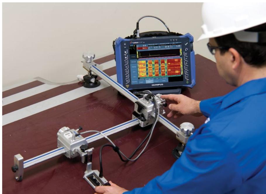
El escáner GLIDER™ de codificación biaxial X-Y es usado para inspeccionar manualmente superficies de compuestos ligeramente curvas o planas.
