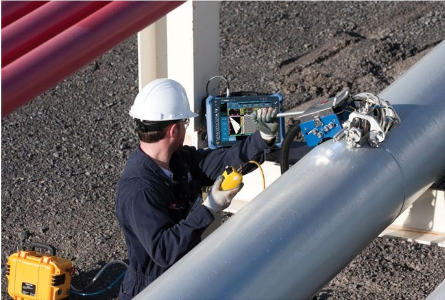
El escáner WeldROVER™ está hecho para clientes que requieren una inspección más estable que la provista por los escáneres manuales y para quienes desean adquirir un paquete más económico de aquellos sistemas de alta discriminación de zona, usados comúnmente en la construcción de tuberías marítimas.
