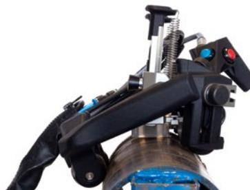
Junto con dos sondas, el escáner AxSEAM puede inspeccionar soldaduras circunferenciales tan pequeñas como de 114 mm (4,5 pulg.) de D. E.
