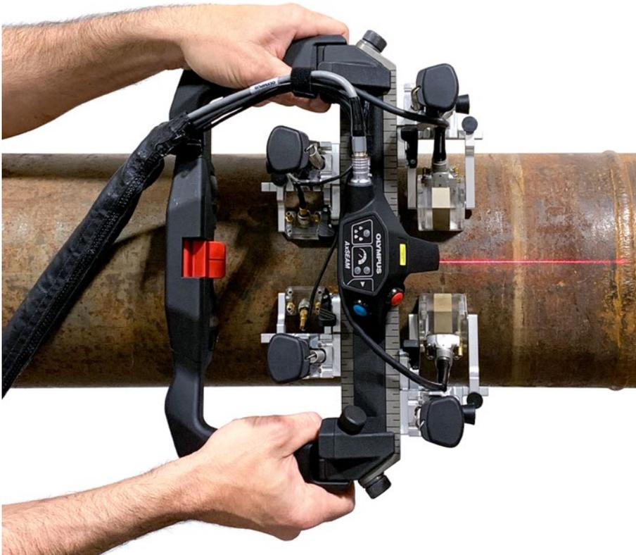
Inspeccionar cordones de soldaduras en tuberías de forma longitudinal puede plantear más desafíos que el escaneo circunferencial. Con tan solo algunos ajustes, el usuario del escáner AxSEAM™ puede alternar fácilmente entre el escaneo longitudinal y el circunferencial, cambiar la separación de las sondas o adaptar el instrumento a los cambios diametrales a lo largo de la tubería.
