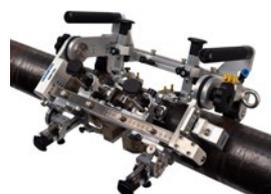
El diseño articulable del escáner HSMT-Flex permite inspeccionar tuberías tan pequeñas como de 4,5 pulgadas (114,3 mm) de diámetro externo hasta con ocho sonda.
