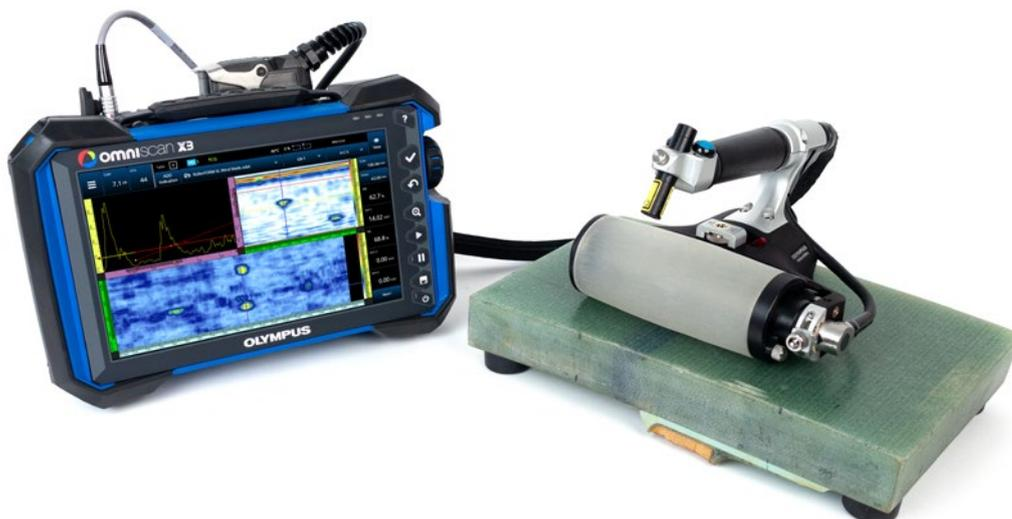
Gracias a su botón de indexación integrado, la estructura ergonómica del escáner RollerForm permite escanear la superficie de un material mediante la adquisición de múltiples C-scan unilineales. Estos escaneos son combinados en tiempo real dentro de una sola representación. Por su parte, la guía láser integrada facilita la rectitud y precisión de los escaneos unilineales.
