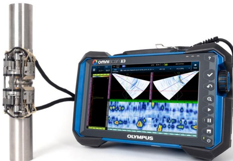
Escáner COBRA en una tubería de 0,84 pulg. con dos sondas *Phased Array* A15 y un detector de defectos OmniScan® X3, representando dos grupos de ultrasonido multielemento mediante escaneos sectoriales y C-scan.
