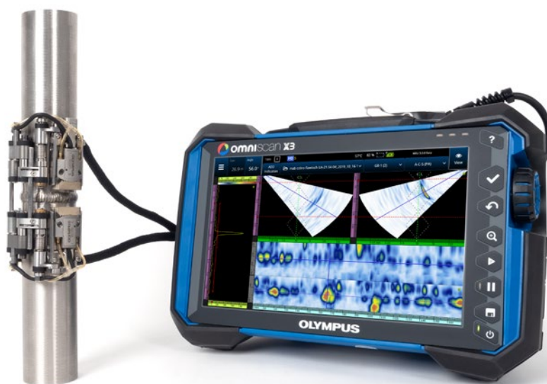
O escâner COBRA em um tubo de 0,84 pol com duas sondas PA A15 com o detector de defeitos OmniScan® MX2 16:64 exibindo dois grupos PA com rastreamento setorial e C-scan.
