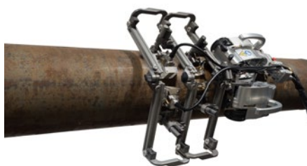
O escâner SteerROVER e o rack de suporte de sonda podem ser dobrados para inspecionar soldas longitudinais.
