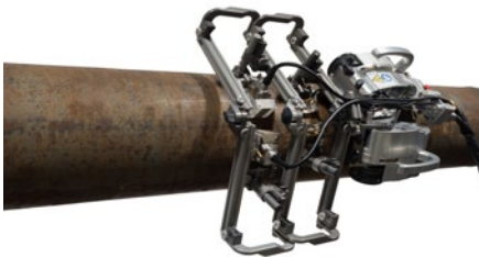
在对纵向焊缝进行检测时，可以使SteerROVER扫查器和支撑探头架的支架呈弯折状态。
