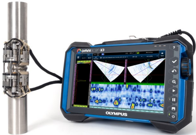
安装在0.84英寸管道上的COBRA扫查器,装有两个A15 PA探头,使用OmniScan MX2 16:64探伤仪,仪器屏幕上以扇形扫描和C扫描形式显示两个PA组。
