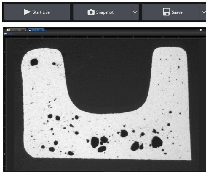
3. 当反射光或透射光没有开启时，请将其开启。为此，请点击 [观测]>[观测设置]>[照明] 组中的相应按钮。(有关详细信息，请参阅在线帮助。)
