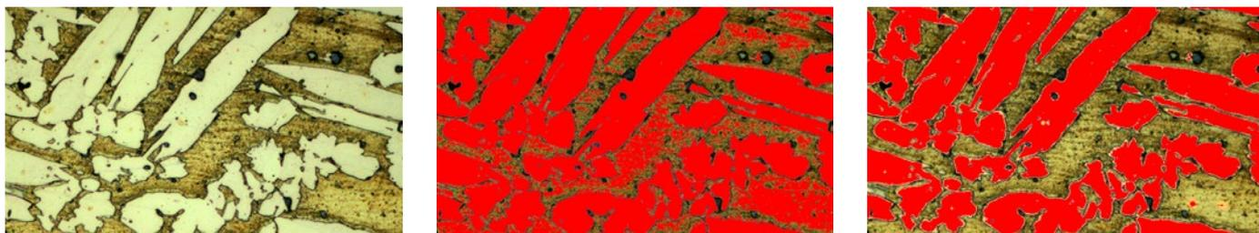
复合材料的多相分析是一种使用深度学习技术完成的典型的工业图像分析应用。使用PRECiV进行图像深度学习分割后, 就可以区分和准确检测不同的晶相。结合PRECiV的计数和测量解决方案, 用户可以很容易地从样品中提取重复和定量的结果。
