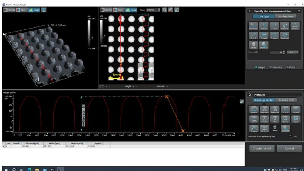
PRECiV可对所有带高度信息的图像进行简单的3D测量（线轮廓）。对于高级测量（例如表面粗糙度、体积测量），PRECiV可将图像直接导出到3D分析应用程序。
