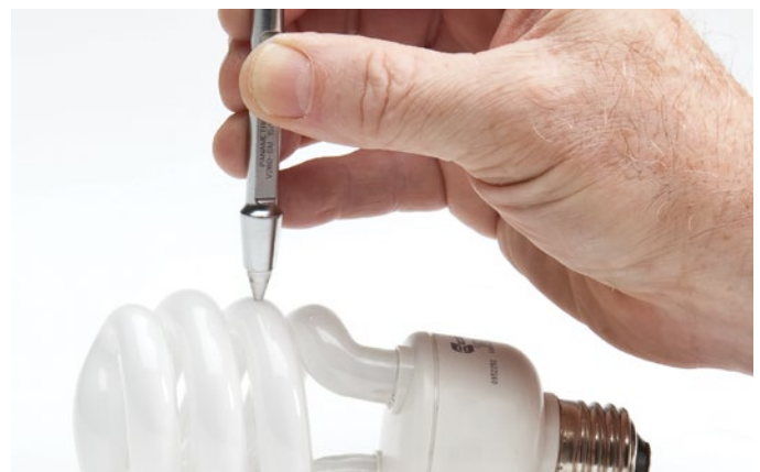
Die Softwareoption für hohe Auflösung ermöglicht Dickenmessungen mit einer Auflösung bis zu 0,001 mm.
