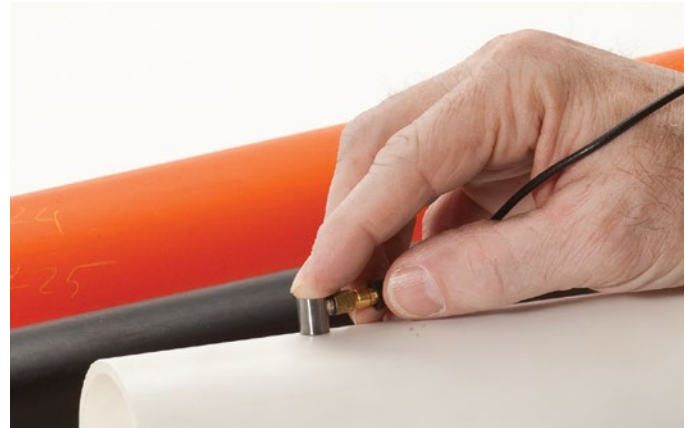
Misst die Dicke vieler Materialien wie Kunststoff, Metall, Gummi, Glas, Keramik und Verbundwerkstoffe.
