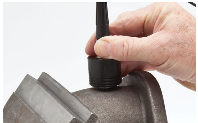
La opción de software Alta penetración posibilita la medición de varias piezas de fundición metálica y materiales de atenuación acústica.
