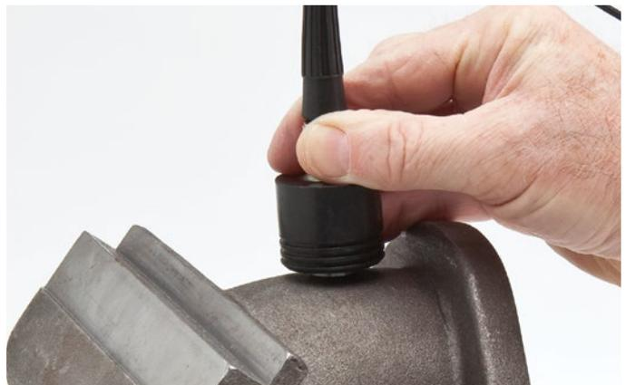
L'option logicielle de haute pénétration permet de mesurer de nombreuses pièces en fonte ou des matériaux atténuants.
