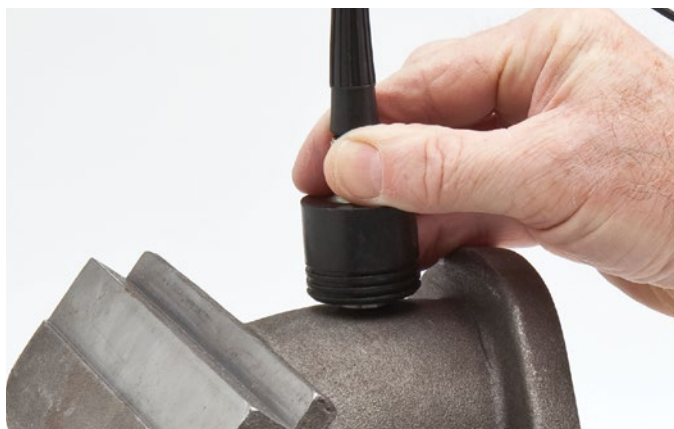
La maggior parte delle componenti in metallo pressofuso o in materiale a elevata attenuazione possono essere misurate con la funzione software opzionale High Penetration.
