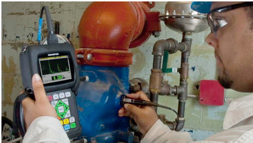
Obrázek 1-1 Měření tloušťky přístrojem 39DL PLUS
