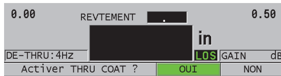
Figure 5-11 Ouverture de la boîte de dialogue pour l'activation de la fonction THRU COAT
