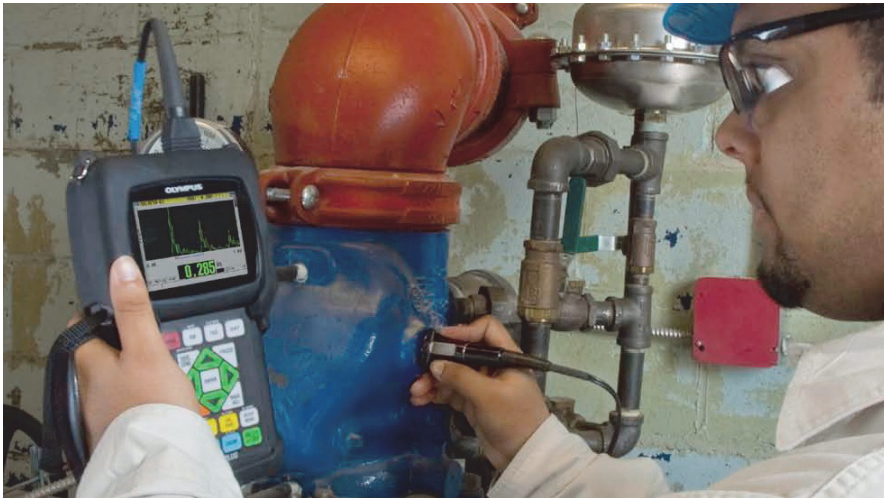
Figure 1-1 Prise de mesures d'épaisseur au moyen du 39DL PLUS
