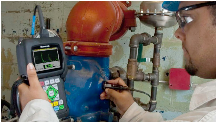
図 1-1 39DL PLUS での厚さ測定
