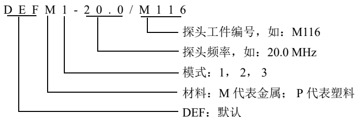
图 5-3 选择默认单晶探头的设置
