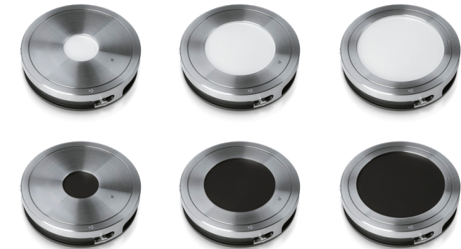
Portamuestras (o soportes de muestras) circular con fondos blanco y negro dedicados a las membranas de filtro de 25 mm (izquierda), 47 mm (centro) y 55 mm (derecha) de diámetro.
