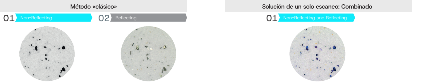
El innovador sistema de iluminación separa partículas reflectantes (metálicas) y no reflectantes (no metálicas) en un solo escaneo.
