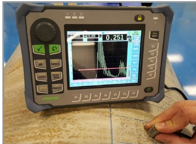
剩余壁厚：0.251英寸（6.375毫米） — 有腐蚀
