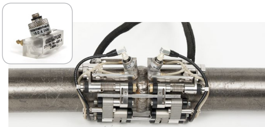
Lo scanner COBRA per le tubazioni di diametro ridotto può realizzare le ispezioni TOFD mediante gli zoccoli, sonde e cavi appropriati.
