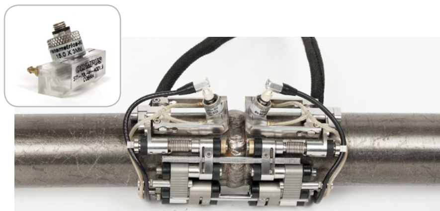
O escâner COBRA pode efetuar inspeções em tubos de diâmetro pequeno com a técnica TOFD com a utilização dos calços, cabos e transdutores apropriados
