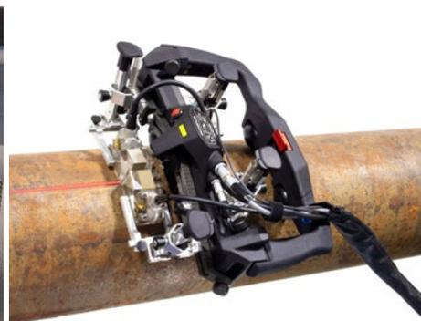
ChainSCANNER扫查器通过链接设备被安装在管道上,可用于对非铁磁性材料进行检测。
