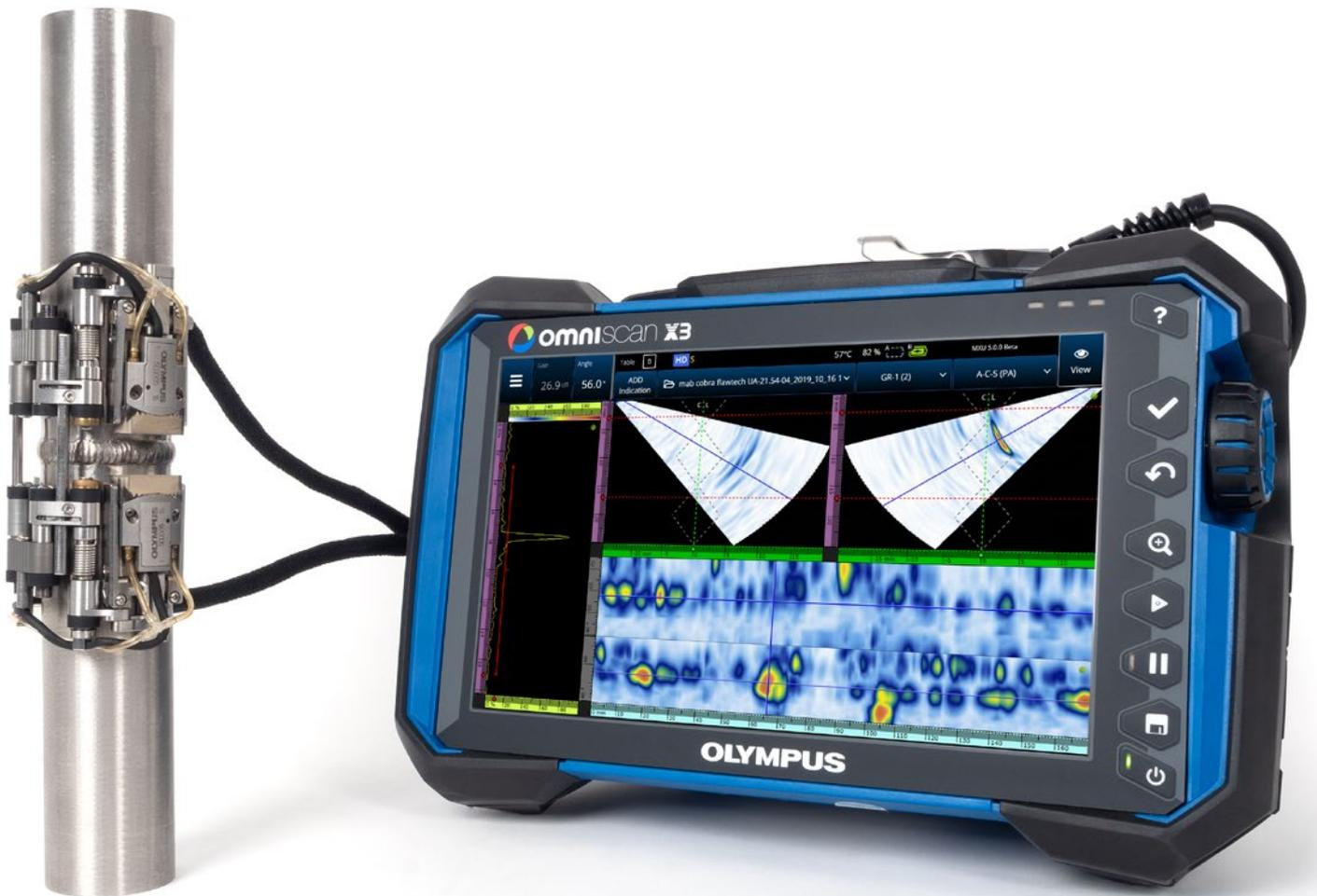
安装在外径为0.84英寸管道上的COBRA扫查器, 装有两个A15 PA探头, 与OmniScan X3探伤仪一起对管道进行检测, 仪器屏幕上以扇形扫描和C扫描形式显示两个PA组。
