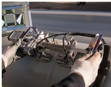
AxSEAM扫查器可用于对外壁直径从6英寸到平面的碳钢管道上的纵向焊缝进行检测。
