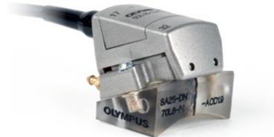
COBRA扫查器还可与晶片直径为3毫米的常规UT探头和特别设计的楔块相兼容，以完成TOFD\*检测。
